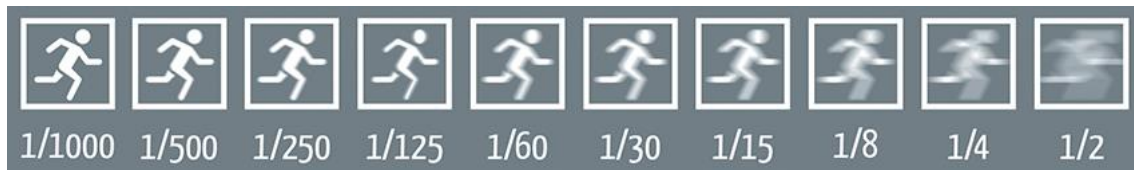
Ejemplo de diferentes tiempos de exposición con un objeto en movimiento
